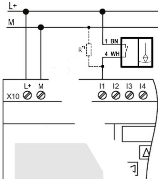
**Bitte beachten:** Bei der Verwendung des Neigungsschalters HNSC-B als Signalgeber an einem digitalen Eingang einer SPS, muss die Steuerung bei Erkennung von Signal 0 einen Reststrom von ca. 600µA tolerieren. Beachten Sie hierfür die Angaben in den technischen Daten der verwendeten Steuerung.
