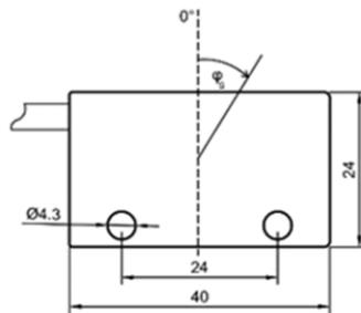
Bezugsebene für den angegebenen Schaltwinkel ist die Gehäuseunterseite.
